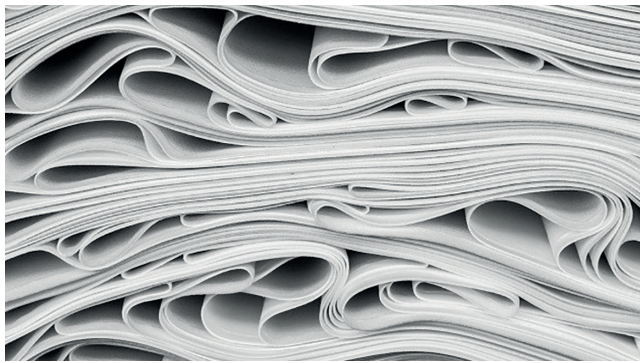
Bild 4. Das Mikrofasermaterial Dinamica wird unter anderem aus alten T-Shirts und PET-Flaschen hergestellt
